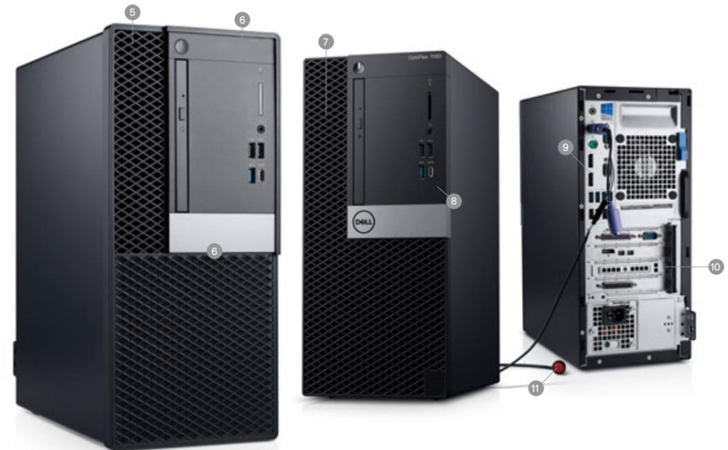
5. 먼지가 많은 환경에서 시스템을 안전하게 보호하기 위한 먼지 필터 커버 옵션 6. 자사 로고 또는 제품명을 별도로 넣을 수 있는 OEM Ready 솔루션 7. ODD, 멀티베이 스토리지 등 다양한 5.25" 기기를 위한 일체화된 디자인의 5.25" 베이 8. 10Gbps의 빠른 속도로 데이터 전송이 가능한 최신 USB 3.1 Gen 2 Type-C 포트 XE3 전 모델 기본 탑재 9. XE3 전 모델 듀얼 디스플레이 포트 기본 탑재 10. 1개의 PCIe x16 슬롯, 1개의 PCIe x4 슬롯 및 1개의 PCI 슬롯으로 그래픽 카드, Thunderbolt 카드뿐만 아니라 아직 많은 공장에서 사용하는 로봇 제어 레거시 PCI 카드 등을 모두 장착 가능 11. 격리된 공간에 설치된 XE3 데스크탑을 손쉽게 켜고 끌 수 있는 리모트 전원 버튼 옵션
